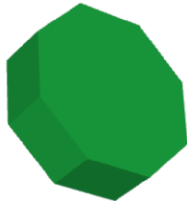
Un hexagone extrudé de 30 unités le long de Z produit une PolyhedralSurfaceZ
